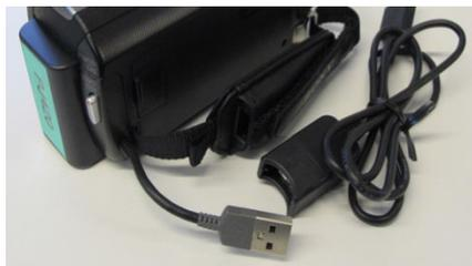
1. Kamera mit USB-Kabel an den Computer anschliessen. Der USB-Stecker befindet sich in der Halteschleufe der Kamera, USB-Verlängerungskabel ist in der Tasche vorhanden.
