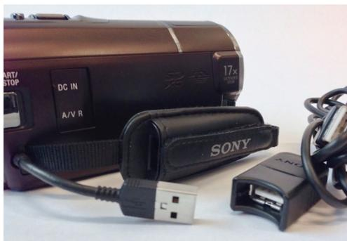
1. Kamera mit USB-Kabel an den Computer anschliessen. Der USB-Stecker befindet sich in der Halteschleufe der Kamera, USB-Verlängerungskabel ist in der Tasche vorhanden.
