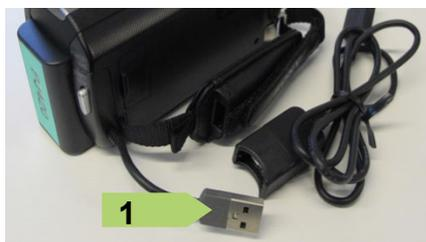
1. Kamera mit USB-Kabel an den Computer anschliessen. Der USB-Stecker befindet sich in der Halteschleife der Kamera, USB-Verlängerungskabel ist in der Tasche vorhanden.
