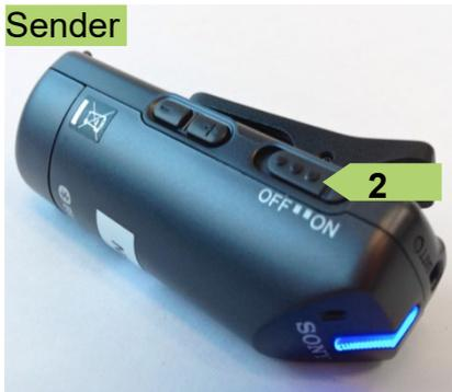
Wichtig: Der Sender (Ansteck-Mik) muss eine Sichtlinie zum Empfänger aufweisen, um eine möglichst gute Tonqualität zu erreichen. Das Mik kann bis zu einer Distanz von 10 Metern eingesetzt werden. Sobald die beiden blauen Lämpchen des Empfängers und des Senders ununterbrochen leuchten, ist das Gerät einsatzbereit. Wenn der Sender rot blinkt, ist die Batterie zu schwach. Eine Batterie hält sicher 90 Minuten (= 2 Lektionen).
